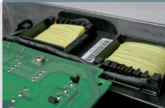
Катушки постоянного тока уменьшают гармонический шум и защищают привод.
