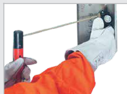
Беспроводные пульты дистанционного управления R11-T можно использовать просто путем касания электрода
